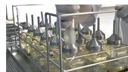
Sistema de abertura e fechamento das tampas de bebedouros;
