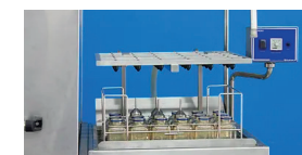
Enchedeira que permite encher até 36 bebedouros ao mesmo tempo.
